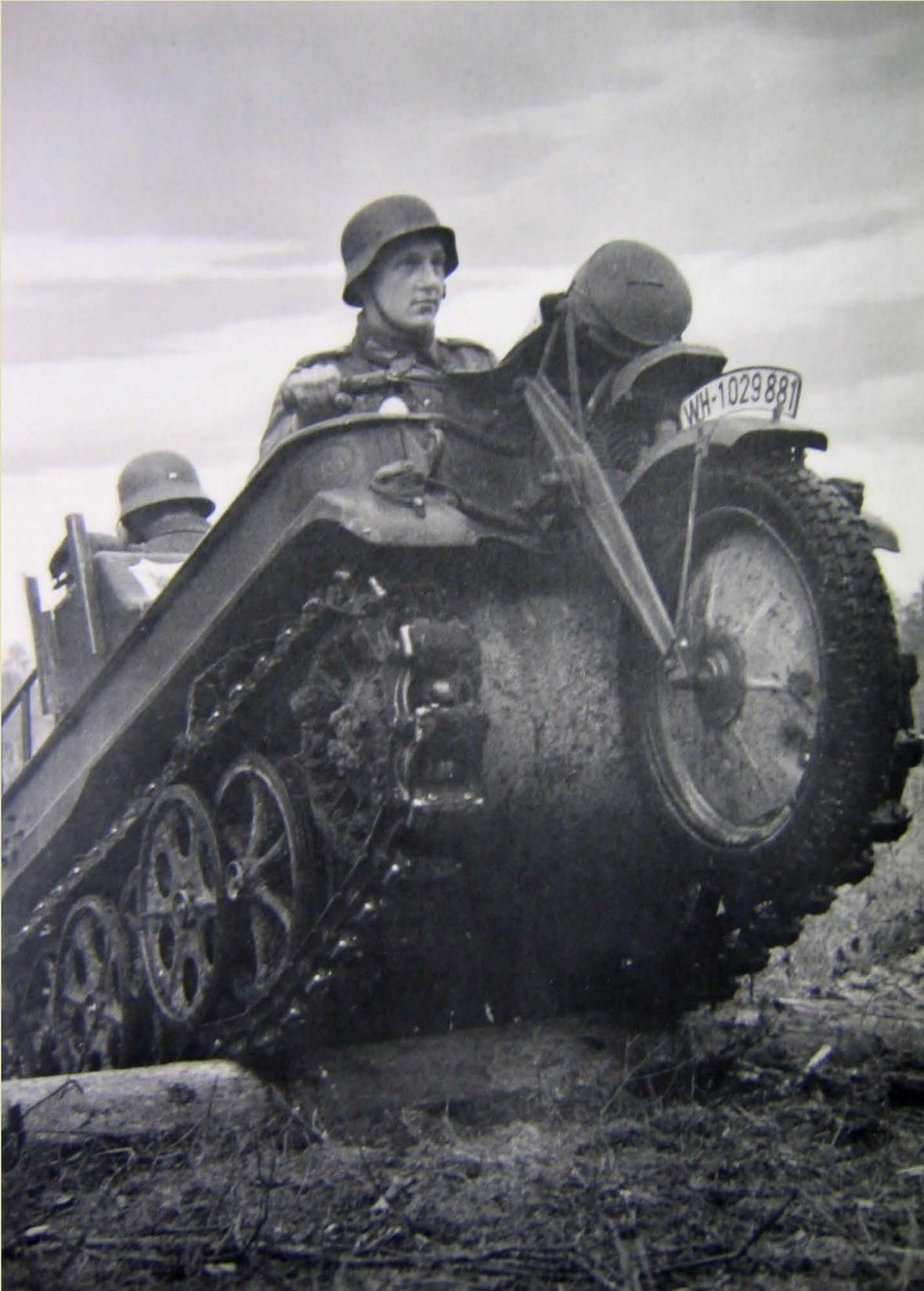
Von 1939 stammte die Forderung des Waffenamtes, ein geländegängiges Zugmittel für kleinere Lasten wie Feldkabel oder Granatwerfer (2 cm FLAK oder 3,7 cm PAK) zu entwickeln. Daraufhin entwickelte Dipl. Ing. Heinrich Ernst ein Fahrzeug mit einer motorradähnlich angeordneten Bedieneinrichtung.
